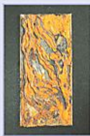
우체리(포징) 표면 녹슨 상태
